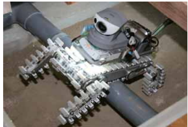
写真2 床下点検ロボット
