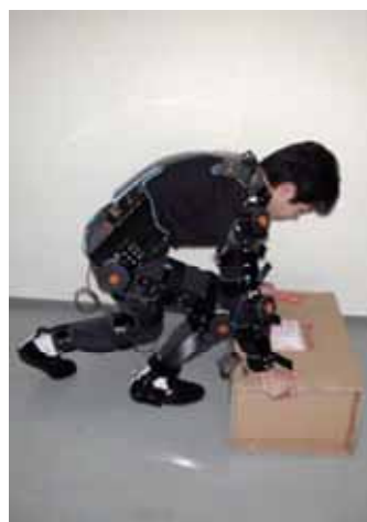
写真20 農業用ロボットスーツによる揚上作業 (農工大)
