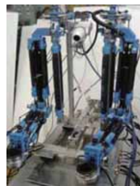
写真7 ゴム人工筋を用いたロボットシステム
