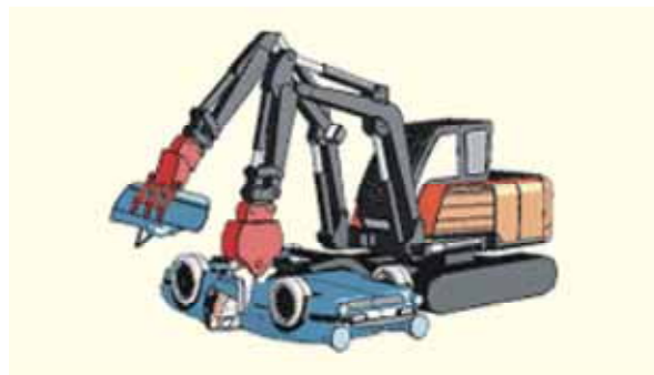
図15 双腕建機による解体作業
