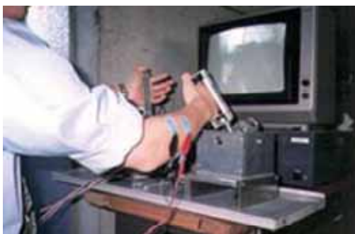
写真3 モニター画面，ジョイスティック，電極から構成される操作部
