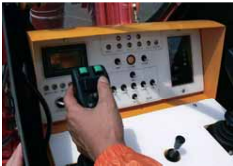
写真20 「T-53援竜」 操縦装置
