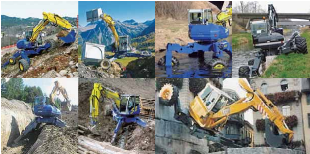
写真8 ウォーキングエキスカベータの様々な作業状況
