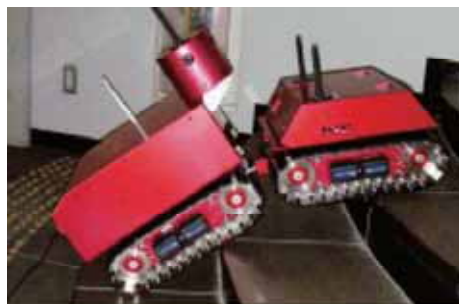
有線機・無線機2台連結による階段昇降 写真1 複数のロボット連結での階段昇降
