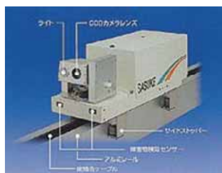
写真3.15 橋梁点検ロボット
