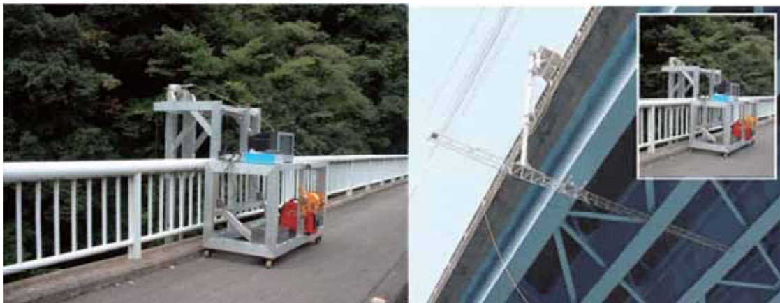
写真3.8 桁下診断システム
