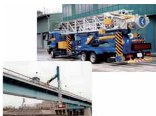
写真3.1 搭乗型の車載式橋梁点検車例
