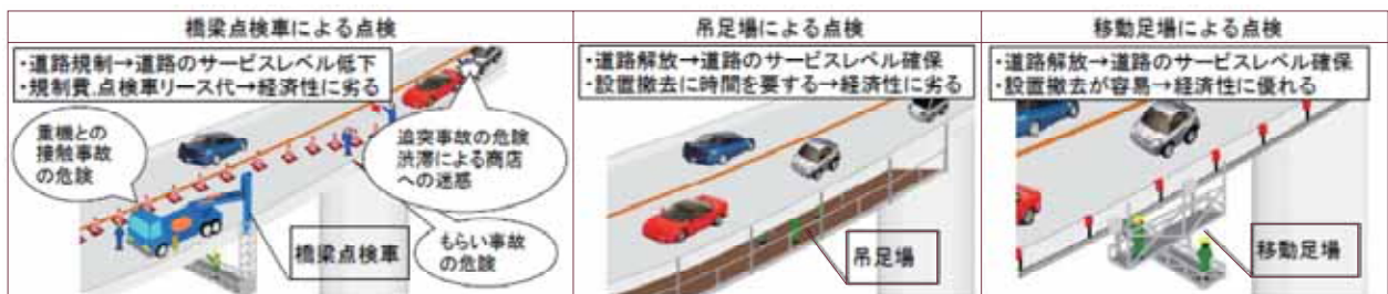
図3-1 橋梁点検車と吊下げ式の橋梁点検装置
