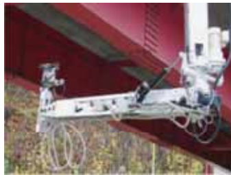
写真3.2 橋梁点検ロボット
