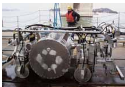
写真3.12 ケーソン壁面清掃ロボット
