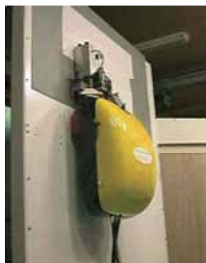
写真3.19 ケレン・塗装ロボット
