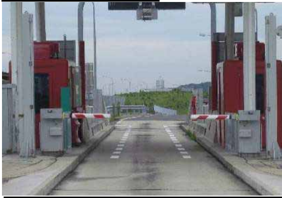
開閉バーの短尺化(間隔約1.5m)
